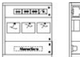
Fig. 3 Esempio di sistemazione dei regolatori in un quadro modulare Example of arrangement of regulators in modular panel
